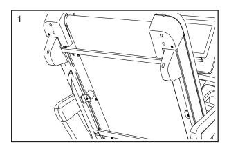
2. Heben Sie den Rahmen (A) an, bis die Lagerungsarretierung (B) in der Lagerungsposition einrastet. VORSICHT: Achten Sie darauf, dass die Lagerungsarretierung einrastet.
