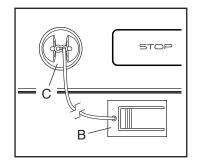
Kleidung. Dann stecken Sie den Schlüssel in den Trainingscomputer. WICHTIG: Im Notfall können Sie den Schlüssel vom Trainingscomputer abziehen, wodurch das Laufband langsam zum Stillstand kommt. Testen Sie die Klemme, indem Sie ein paar Schritte rückwärts gehen. Wird dabei der Schlüssel nicht vom Trainingscomputer abgezogen, dann passen Sie die Position der Klemme an.
